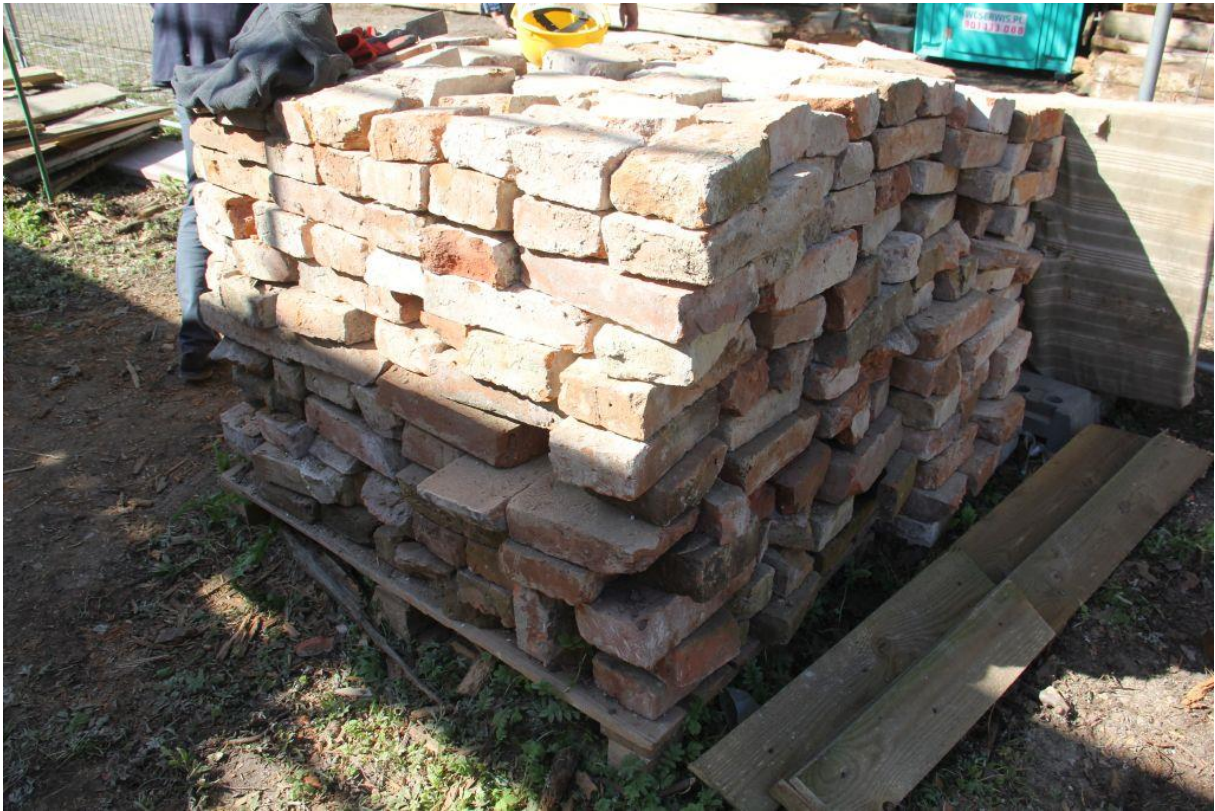
Fot. Do murowania można wykorzystać cegłę rozbiórkową ze spichrza.
